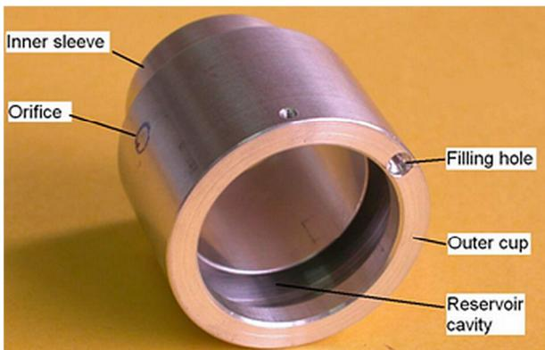
Fig. 4. Centrifugal lubricator.
